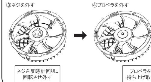
ネジを反時計回りに回転させ外す
