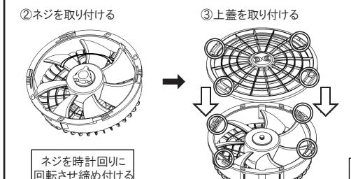
ネジを時計回りに回転させ締め付ける
